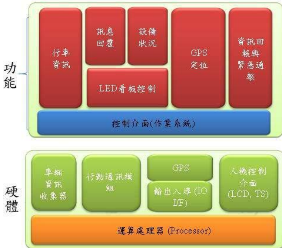
圖 3-1 智慧巴士 4G 專用車載機系統架構圖
