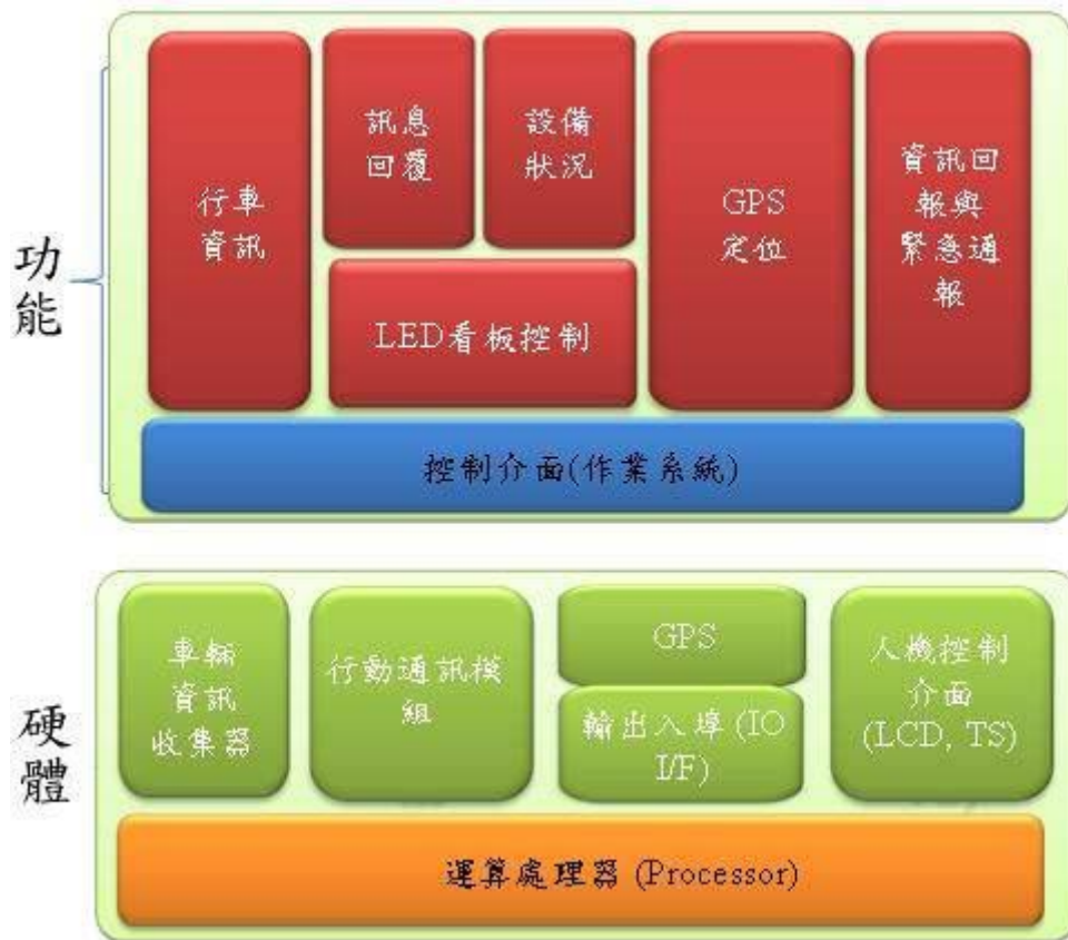
圖 3-1 營業大客車車載機系統架構圖
